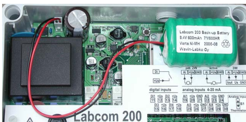
Kuva 2-2. Labcom 200 paristovarmennuksen liittäminen
