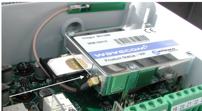
Kuva 4. SIM -kortin asentaminen
