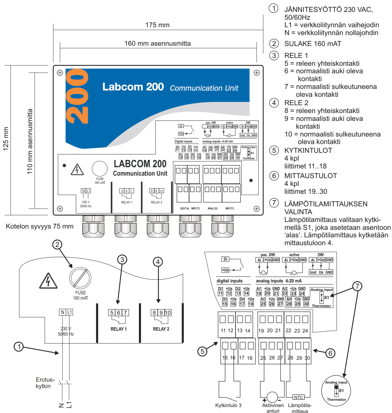
Kuva 2. Labcom 200 (230 VAC) rakenne ja liitynnät
